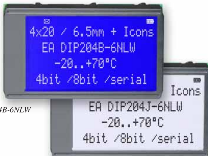
EA DIP204J-6NLW: Abmessungen 75 x 46 mm
